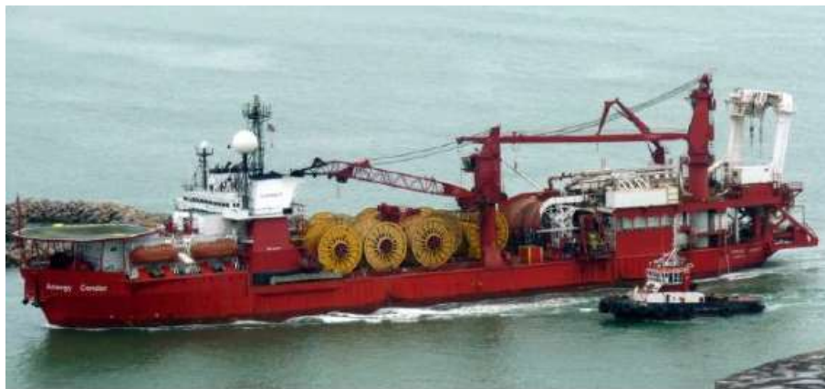
Figura 18 – Navio instalador com sistema de lançamento horizontal (HLS) [14]
