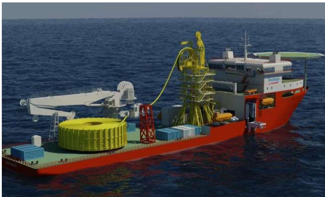
Figura 19 – Esquema de lançamento de duto flexível pelo sistema de lançamento vertical (VLS) [15]
