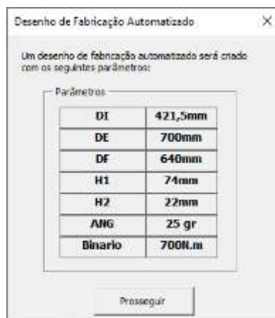
Figura 71 – Parâmetros que serão importados para o desenho de fabricação automatizado
