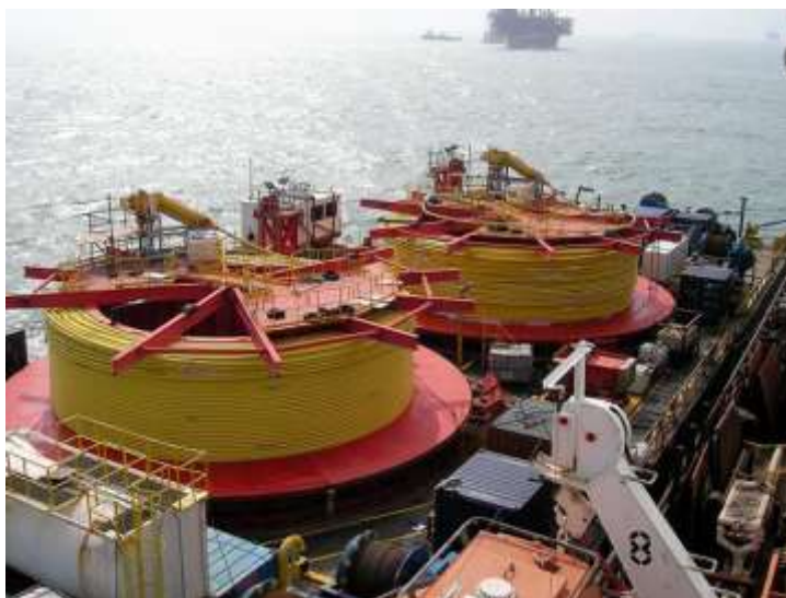
Figura 15 – Armazenamento de tubulações flexíveis nos navios instaladores [11]
